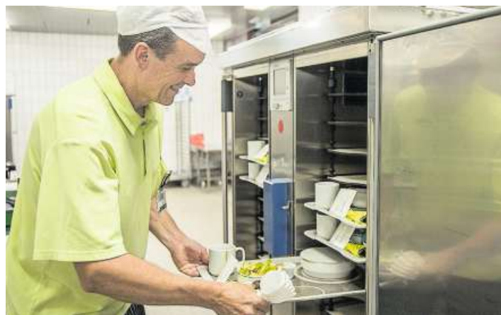
Ein Mitarbeiter füllt einen der Regenerierwagen mit den bestückten Tablett. Induktionsspulen erwärmen später das Essen.
