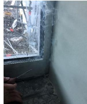
Prüfung mittels eingeblasenem Rauch
