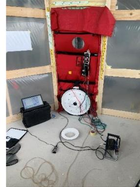
Einbau des Gerätes in einer Tür als «Gebläse-Tür-Messung» oder auch Blower Door Test
